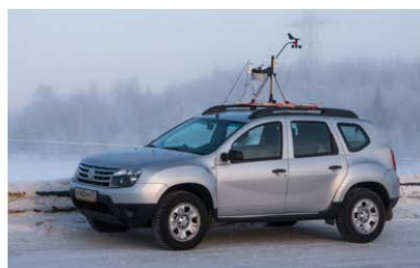
Рис.3. Мобильный измерительный комплекс Davis Vantage Pro на основе арендованного Renault Duster. Фото М.И.Варенцова.
