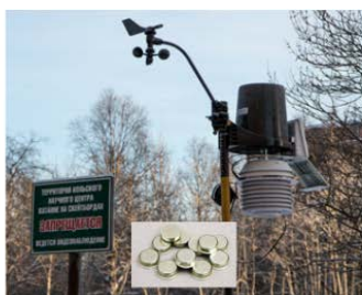
Рис.2. Высокоточный измерительный комплекс Davis Vantage Pro на центральной площади города Апатиты. Термохронные датчики (внизу слева).
