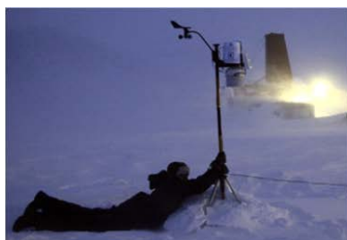
Рис.1. Установка метеостанции в пригороде Норильска в пургу, при температуре -22 градуса и при ветре 17 м/с. Фото М.И.Варенцова.
