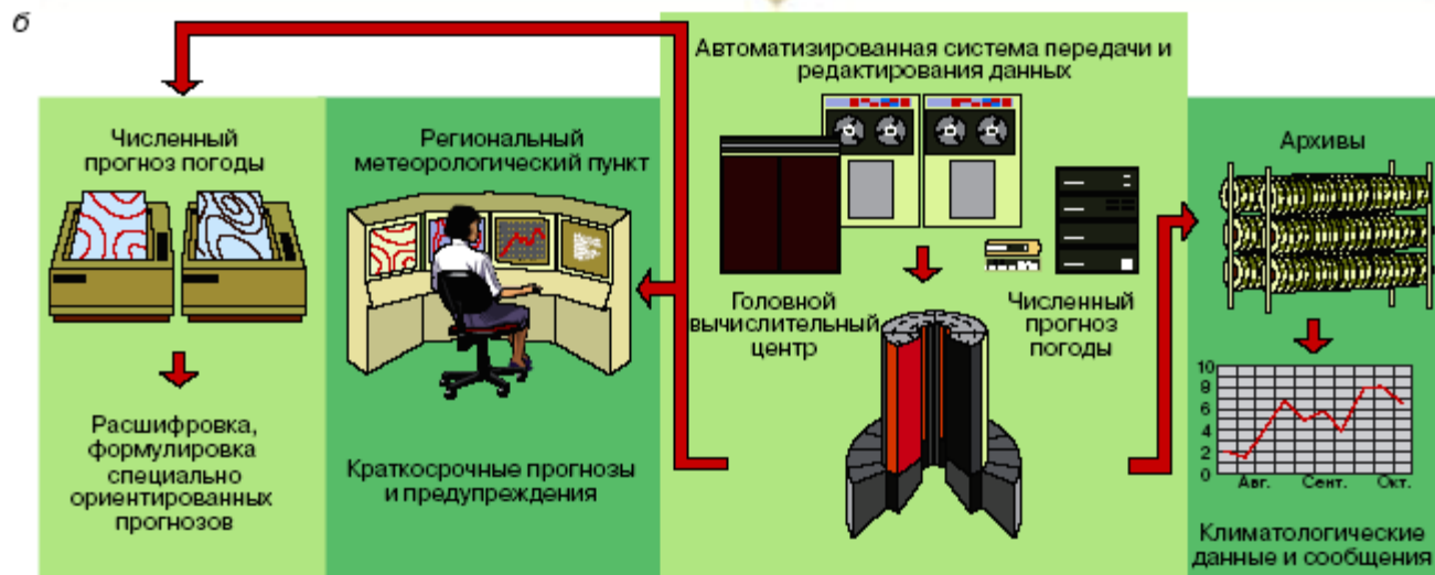
Рис. 1. Диаграмма системы наблюдений (а), сбора и обработки (б) данных наблюдений за состоянием гидросферы Земли (из сб. "Технология сбора и передачи метеорологических данных". М.: ВМО, 1995)
