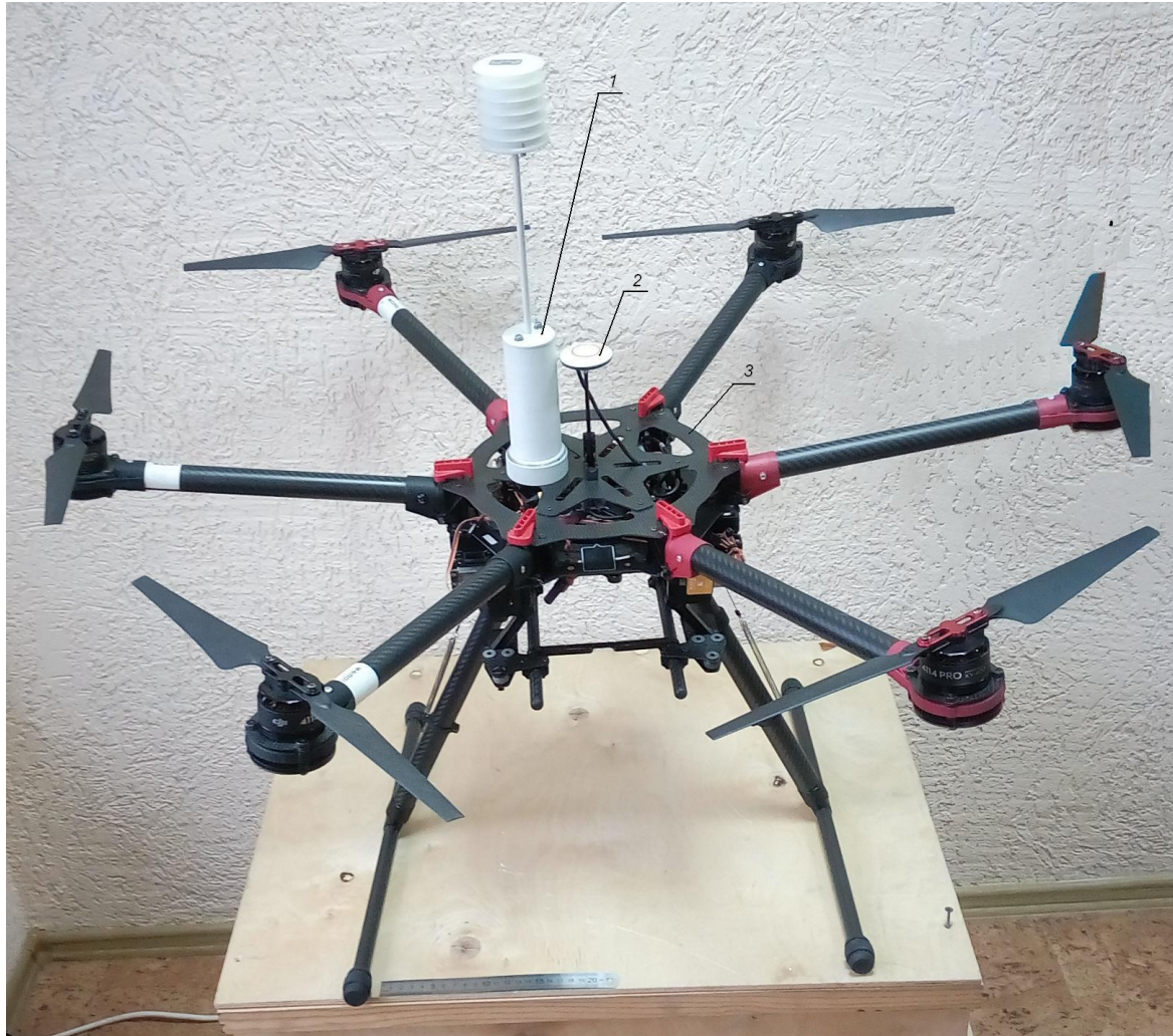
Изготовленный образец АМС/БПЛА, установленный на гексакоптер: 1 – АМС/БПЛА; 2 – навигационный блок GPS, 3 – гексакоптер DJI S900
